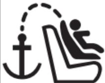
4. Следует закрепить якорный ремень к точке крепления, предусмотренной в автомобиле и обозначенной символом:
